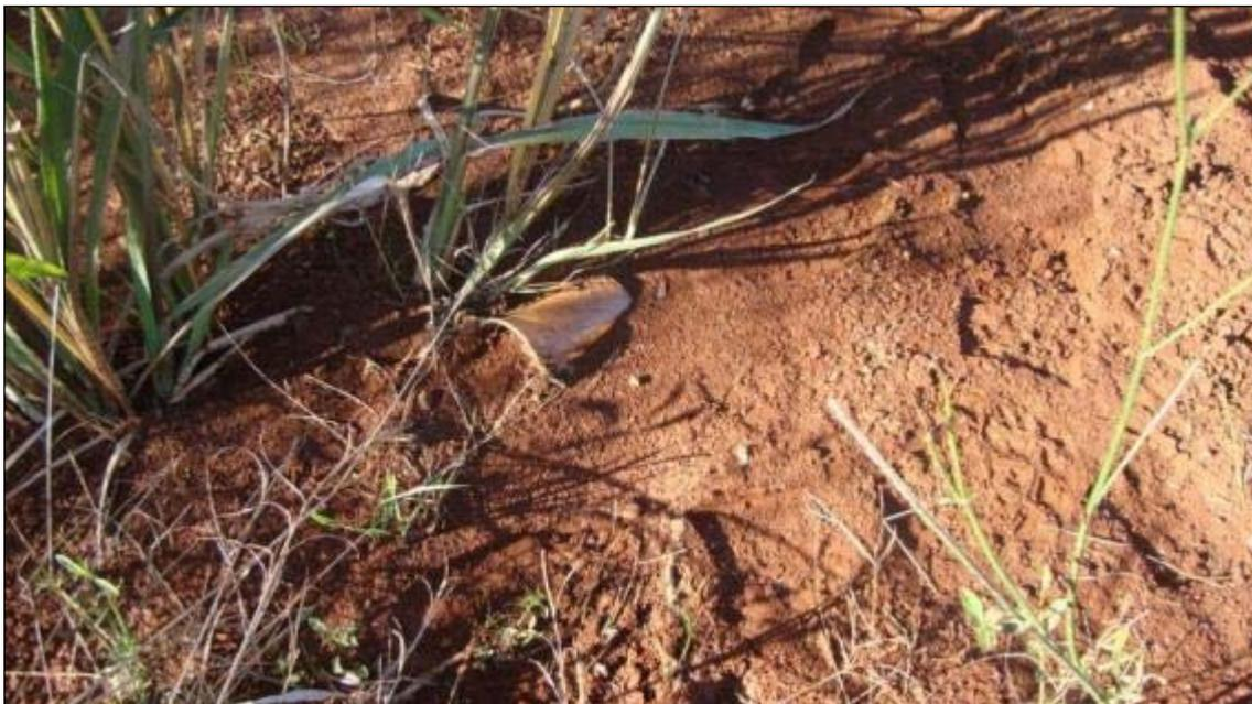
**Foto 21:** Indicando a magnitude do transporte de sedimentos e do assoreamento provocado pela ausência de cobertura vegetal na face de taludes, que potencializa os efeitos erosivos do escoamento superficial. Em pouco tempo, o copo de plástico foi preenchido e já se encontra praticamente soterrado.
