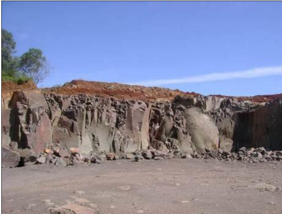
Foto 01 – Visão frontal da pedreira da Itax, no município de Tapejara, mostrando rocha basáltica sã, com características visuais que a indicam a sua boa qualidade.
